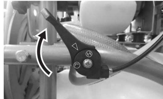
3. 機械の異常の有無を確認のうえ、調圧ハンドルを回して、「除草」「中圧」「高圧」と作業条件にあった圧力の設定をします。
