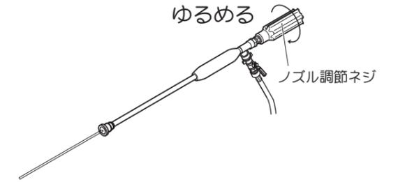
**⚠ 注意** 締め切り状態で長時間放置しないで下さい。ポンプ故障の原因となります。
